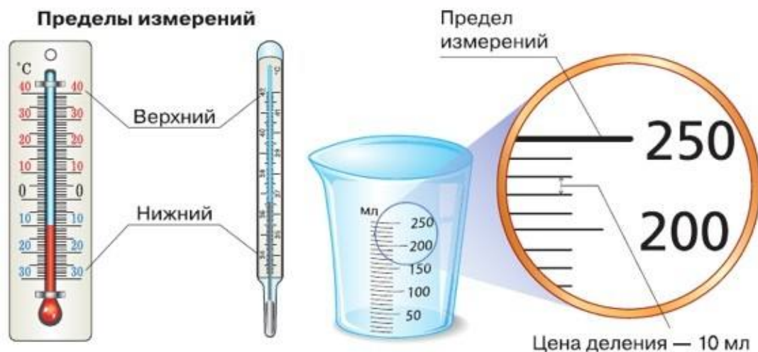
Рис. 22. Предел измерения и цена деления шкал измерительных приборов
