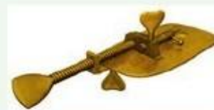
Рис. 47. Микроскоп А. Левенгука
